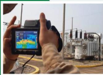
Es una técnica que permite medir y visualizar a distancia y sin ningún tipo de contacto, las temperaturas de operación de los activos.
