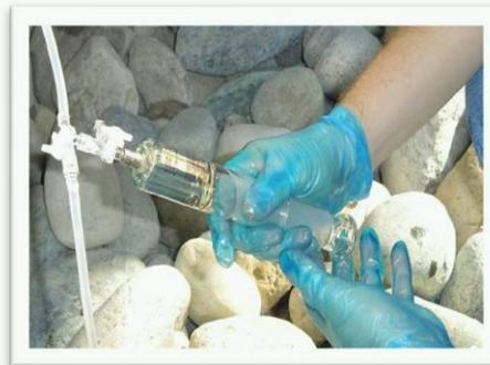
Los diferentes ensayos al líquido aislante son una valiosa herramienta para establecer el estado de un transformador ya que permiten hacer un correcto diagnóstico, con el objeto de resguardar y extender su vida útil y evitar la ocurrencia de fallas imprevistas.
